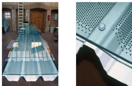
*Slika 8. Slegnuta konstrukcija stalenih panela perforirani čelični lim*
