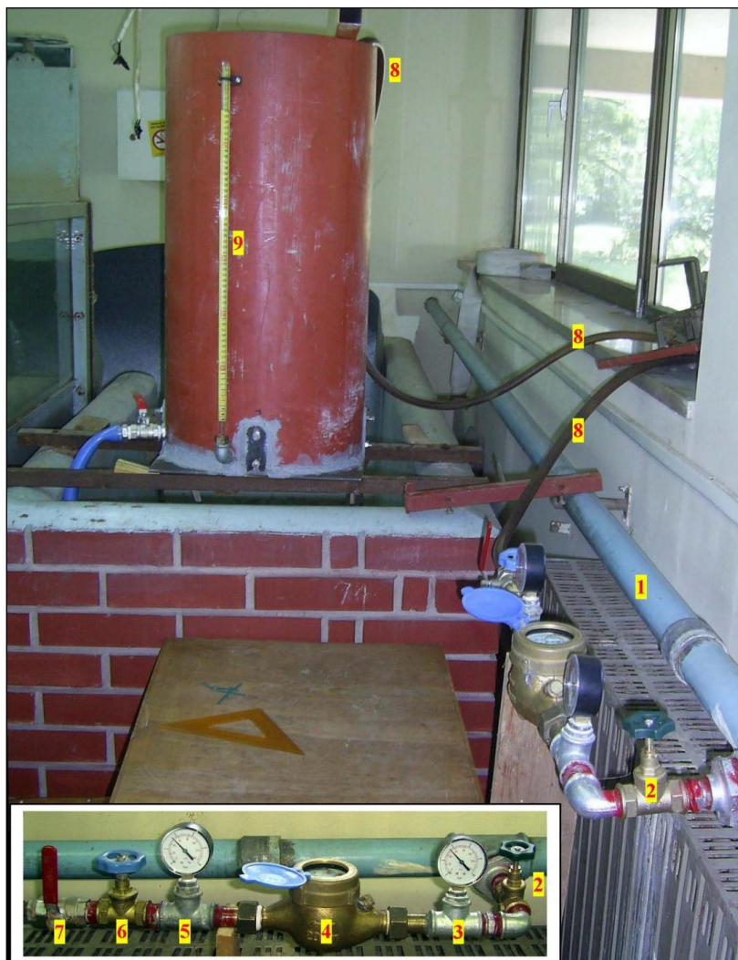
Nova instalacija za ispitivanje mogućnosti merenja hidrograma vode u hidrauličkoj laboratoriji Građevinskog fakulteta u Subotici 1 – vodovodna cev, 2 – propusni ventil, 3 – uzvodni manometar, 4 – vodomer, 5 – nizvodni manometar, 6 – propusni ventil za regulisanje proticaja, 7 – propusni ventil za regulisanje trajanja protoka vode, 8 – odvodno crevo, 9 – bure sa pijezometrom
